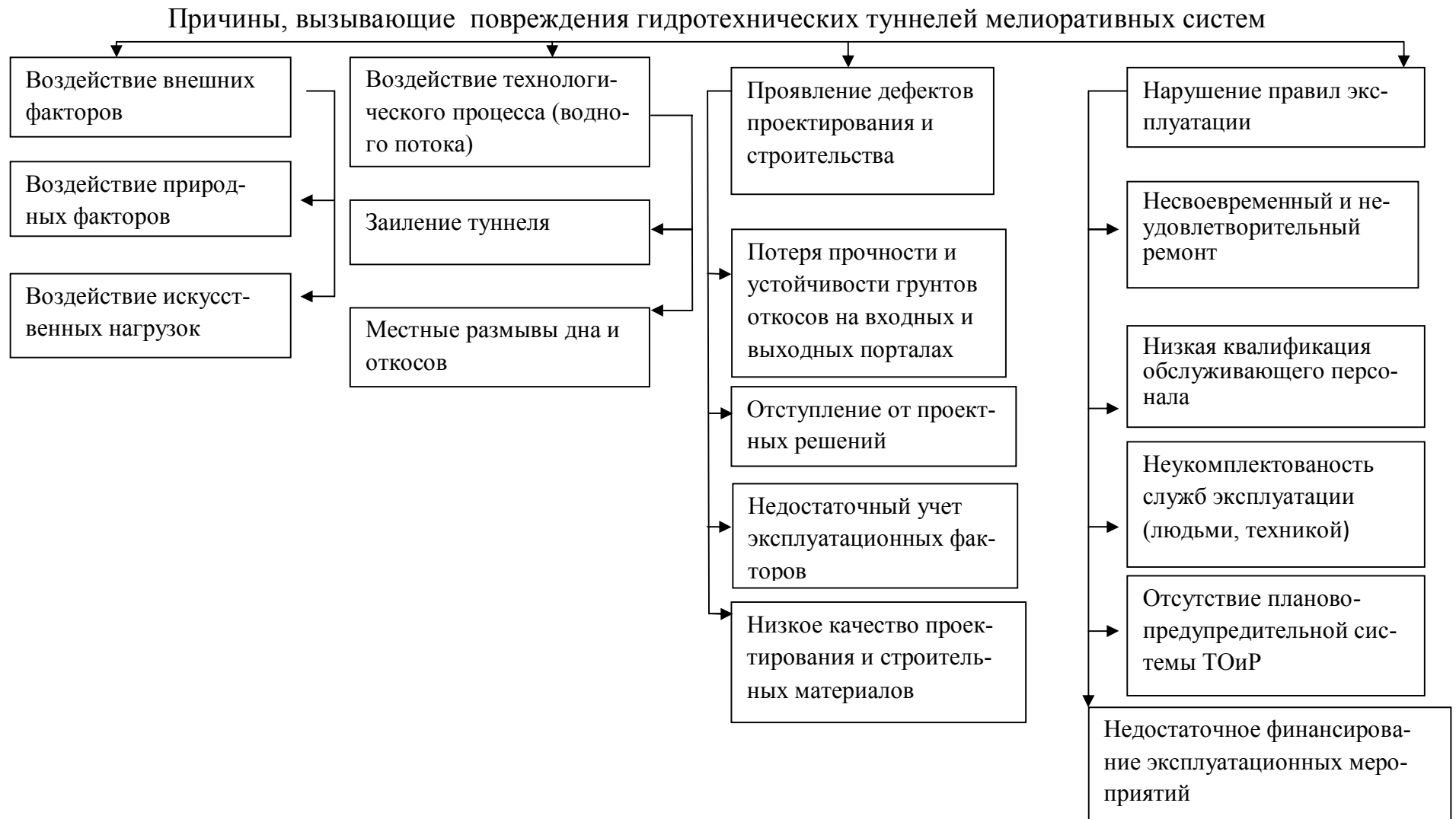
Рисунок 3 – Причины, вызывающие повреждение гидротехнических туннелей мелиоративных систем
