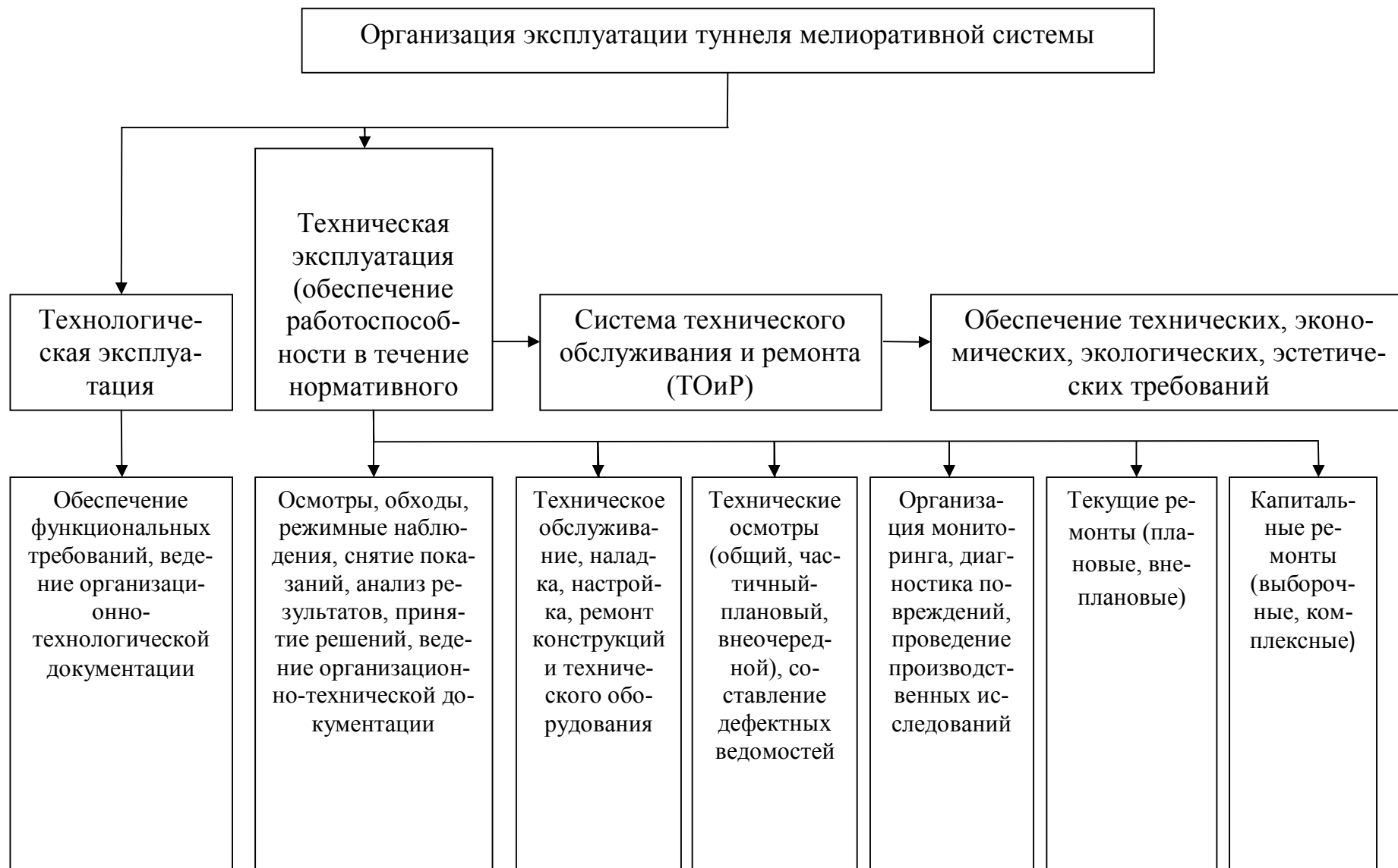
Рисунок 2 – Схема организации эксплуатации туннелей мелиоративной системы
